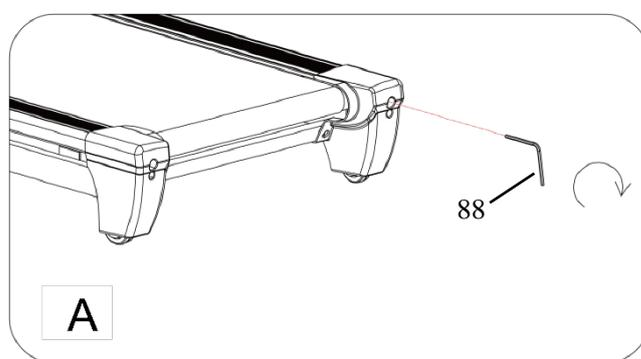
Si la **Cinta Transportadora (n.º 50)** se mueve hacia la izquierda, entonces gire el perno de ajuste del lado izquierdo una vuelta de  $\frac{1}{4}$  *hacia la derecha*, luego gire el perno de ajuste del lado derecho una vuelta de  $\frac{1}{4}$  *hacia la izquierda*. Si la **Cinta Transportadora (n.º 50)** no se mueve, siga ajustando  $\frac{1}{4}$  de vuelta cada vez hasta que se centre. Consulte la Figura B.
