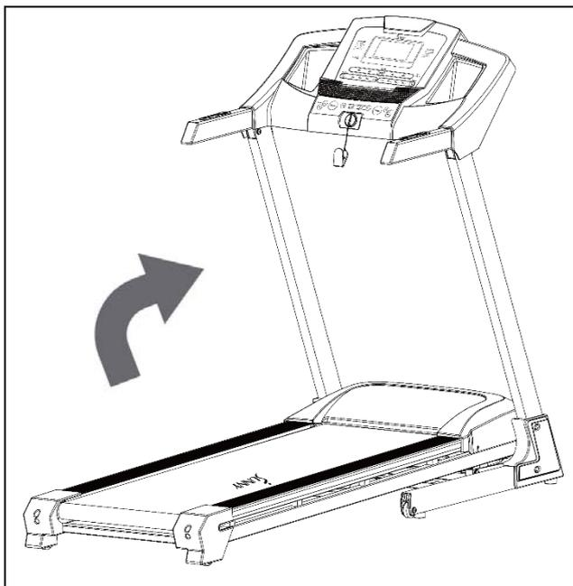
**REMARQUE:** Vérifier que l'inclinaison est à ZÉRO avant le pliage et le dépliage.
