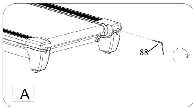
Si la **Bande De Course (N° 50)** se déporte vers la gauche, tourner les boulons de réglage du côté gauche d' $\frac{1}{4}$  de tour dans le *sens horaire*, puis tourner celui de droite d' $\frac{1}{4}$  de tour dans le *sens antihoraire*. Si la **Bande De Course (N° 50)** ne bouge pas, continuer à l'ajuster d' $\frac{1}{4}$  de tour à la fois jusqu'à la centrer. Se reporter à la Figure B.
