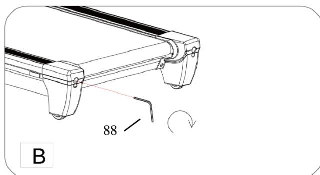
Avec le temps, la **Bande De Course (N° 50)** va se détendre. Pour tendre la **Bande De Course (N° 50)**, tourner les boulons de réglage de gauche et de droite d'un tour complet dans le *sens horaire*, vérifier la tension de la **Bande De Course (N° 50)**. Poursuivre ce procédé jusqu'à ce que la **Bande De Course (N° 50)** soit à la tension souhaitée. Veiller à régler les deux côtés de façon identique pour assurer le bon alignement de la bande. Se reporter à la Figure C.
