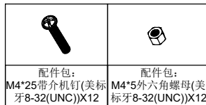
D)结构连接B: 灯体和转角排位,每支灯一端的端盖穿上3颗M4*25螺丝,穿过转角,对应螺丝的位置装上螺母
