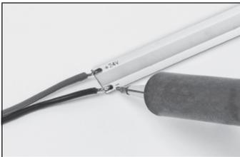
Raccordement des fils
