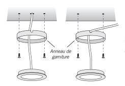
Passer le câble d'alimentation à travers la surface de l'armoire ou l'encoche de l'anneau de garniture.
