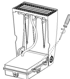
4. Tirez les fils d'alimentation par l'ouverture du conduit de la plaque arrière et faites la connexion de fil comme indiqué sur le diagramme de câblage, puis fixez la plaque arrière à la jonction-boîte
