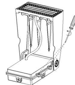
4. Tirez les fils d'alimentation par l'ouverture du conduit et faites la connexion de fil comme indiqué sur le diagramme de câblage, puis fixez la plaque arrière au mur.
