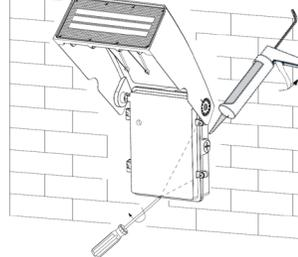
2. Ouvrez le boîtier arrière, déconnectez le connecteur rapide (entre le module LED et le pilote LED) à l'intérieur de l'appareil et retirez le boîtier avant
