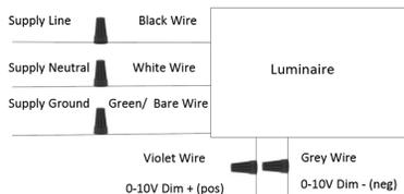
Pour les fils de gradation, utilisez des méthodes de câblage de classe 1.
