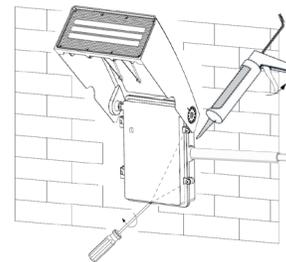
2. Ouvrez le boîtier arrière, déconnectez le connecteur rapide (entre le module LED et le pilote LED) à l'intérieur de l'appareil et retirez le boîtier avant
