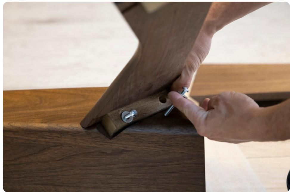
**4** Sur une patte, fixez une des entretoises courtes à l'aide des vis machine 1/4"-20 x 2" et rondelles 5/16".
