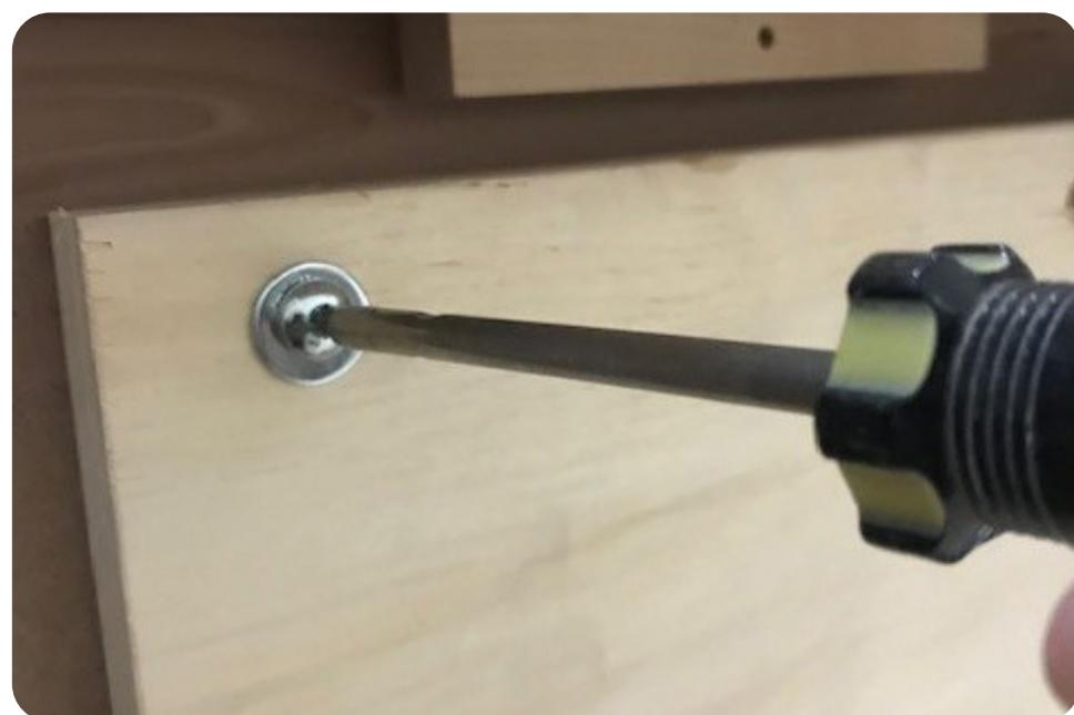
**21** Fixez bandes, surface et supports avec les vis machines 1/4"-20 x 2 1/2" et les rondelles plates 5/16" Ceci redressera complètement la surface.
