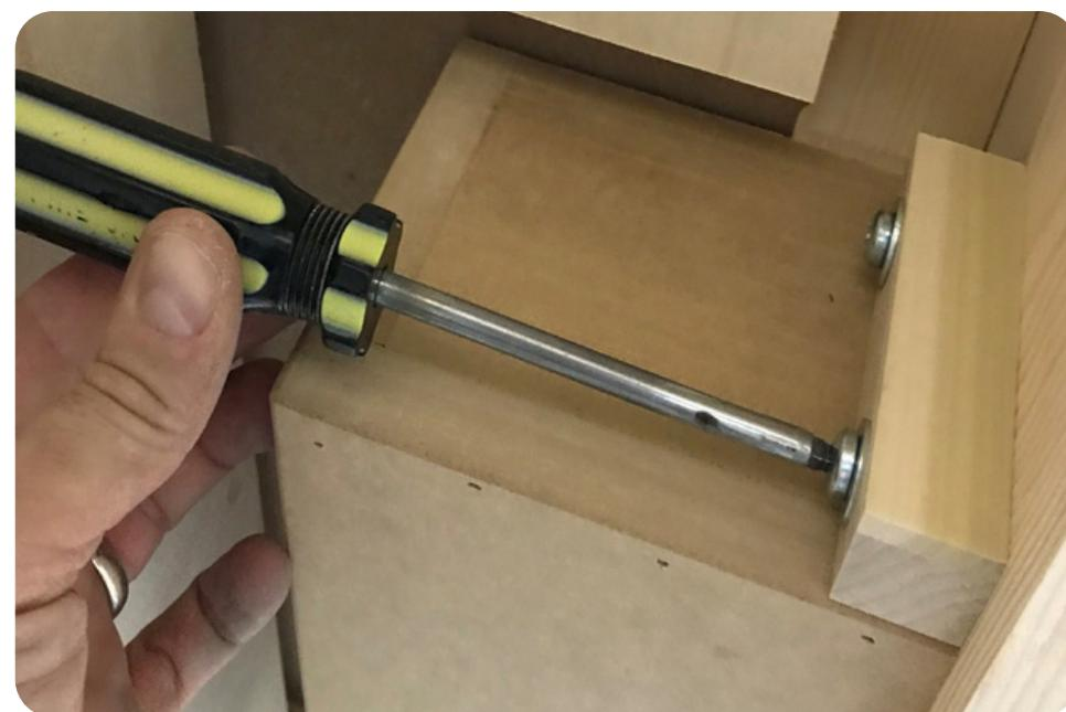
**22** Fixez les butts aux Panneaux courts avec les vis machine 1 1/2" et les rondelles 5/16".
