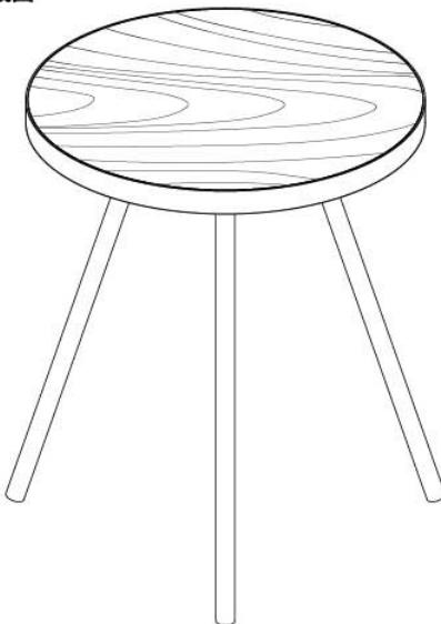
※脚を分解した際に、脚のネジが天板側に残ることがあります。その後、再度組み立てる時には天板側に残ったネジに脚をねじ込めば、問題なくご使用いただけます。
