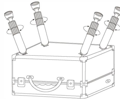
④ C 脚部の取り付けが完了したら、A 本体を持ち上げて起こしてください。脚部は 3 段階まで高さの調節が可能です。
