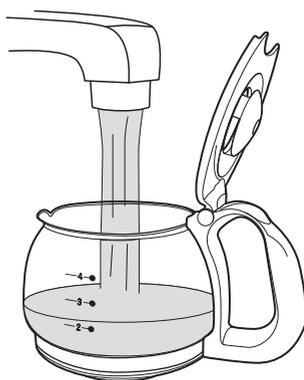
5. ガラスポットに入れた水を水タンクに入れて、ガラスポットを保温プレートの上にのせてください。
