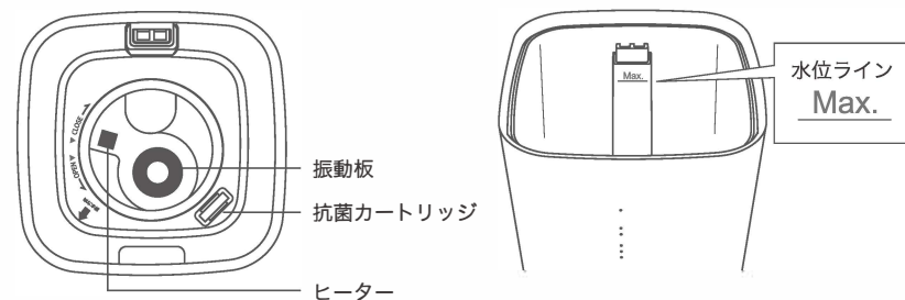
本体内部(ミストダクトを外した状態)
