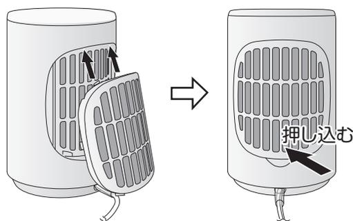
② フィルター枠の下部を押し込む
