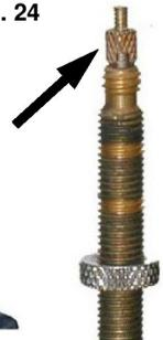
mit einer Fahrradpumpe mit Presta-Kopf auf, indem Sie die Ventilkappe abnehmen, die kleine Kontermutter (Pfeil) gegen den Uhrzeigersinn abschrauben und den Ventilschaft nach unten drücken, um ihn zu befreien (dadurch wird auch Luft aus dem Schlauch gelassen). Schieben Sie dann den Pumpenkopf auf den Ventilkopf und pumpen Sie auf. Danach ziehen Sie die Kontermutter wieder an und setzen die Kappe auf.
