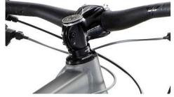
**Anpassung der Steuerposition.** Der Winkel der Brems- und Schalthebel und ihre Position am Lenker können verändert werden. Bitten Sie Ihren Whyte-Händler, die Anpassungen für Sie vorzunehmen. Wenn Sie den Winkel des Steuerhebels selbst anpassen möchten, müssen Sie die Klemmbefestigungen mit dem empfohlenen Drehmoment nachziehen. Die Werte für das Anzugsdrehmoment finden Sie in der Zusatzanleitung für Ihr spezielles Whyte-Fahrradmodell.
