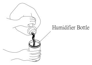
FIGURE 1 — FILLING THE HUMIDIFIER
