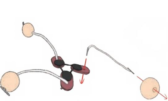
16 將轉盤器的黃色橡皮筋拉出，並套在馬達組的凹槽處（滑輪槽）
