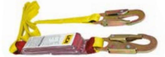
Amortiguador de impacto con cable de nailon, banda de 1" de grosor, ganchos de doble seguro en los extremos. La banda del cable está impregnada de una resina para brindar mayor durabilidad y resistencia a la abrasión. Este tipo de banda es excelente para aplicaciones donde el trabajador requiere moverse con frecuencia.
