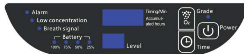
Fig.4 – Schema del pannello operativo
