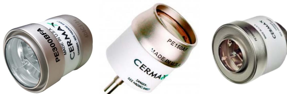
Se recomiendan las fuentes de alimentación reguladas por corriente o por voltaje con ondulaciones de salida de menos del 5%. Se recomiendan impulsos de encendido de disparo único porque los arrancadores de radiofrecuencia pueden dañar el reflector interno de las lámparas. Además de las lámparas, Excelitas Technologies fabrica fuentes de alimentación para lámparas de arco de xenón Cermax®, soportes para lámparas, sistemas de iluminación OEM y fuentes de luz de fibra óptica.
