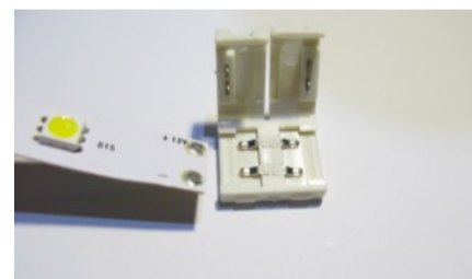
Mete la tira (de un solo color) en el conector.
