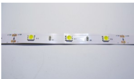
Cada 3 LEDs se puede cortar la tira.
