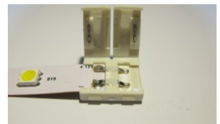
Verifica que la conexión sea segura y cierra la tapa de protección.
