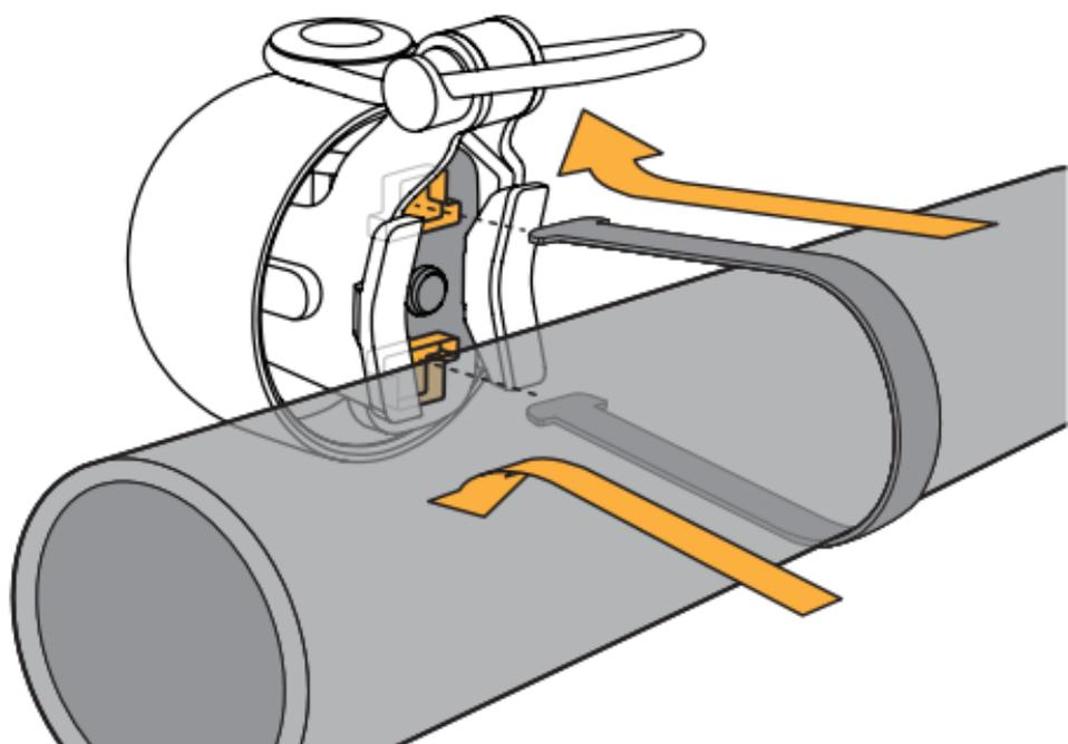
**3** POSITION BELL FORWARD OR UPRIGHT ON YOUR HANDLEBAR. MAKE SURE THE DOME IS NOT TOUCHING ANY CABLES OR BRAKE LEVERS. SECURE WITH 2.5MM HEX. DON'T OVER TIGHTEN.
