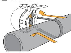
POSITION BELL FORWARD OR UPRIGHT ON YOUR HANDLEBAR. MAKE SURE THE DOME IS NOT TOUCHING ANY CABLES OR BRAKE LEVERS. SECURE WITH 2.5MM HEX. DON'T OVER TIGHTEN.
