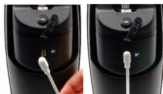
La desconexión del cargador de la prótesis o de la red eléctrica se confirma con una vibración. Cierre bien el tapón, ya que existe el riesgo de que las partículas metálicas se magnetizan e impidan que el conector se conecte correctamente.
