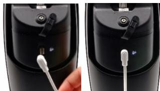
La déconnexion du chargeur de la prothèse ou du secteur est confirmée par une vibration. Bien refermer le bouchon car il y a un risque d'aimantation de particules métallique qui empêcheraient le bon raccordement du connecteur.
