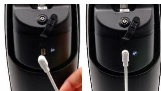
Odpojení nabíječky od protézy nebo od sítě je rovněž potvrzeno vibrací. Nasaděte zpět krytku konektoru ráděně, protože existuje riziko magnetizace kovových částic, které by bránily správnému připojení konektoru.
