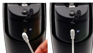
Das Trennen des Ladegeräts von der Prothese oder vom Netz wird durch eine Vibration bestätigt. Schließen Sie die Abdeckung sorgfältig, da die Gefahr besteht, dass Metallteilchen durch den Magneten angezogen werden und der Stecker nicht richtig schließt.
