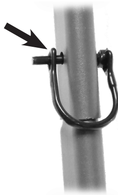
Figure 32 Les goupilles à ressort doivent être engagées positivement
