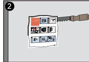
2 Using dotted line on instruction guide, cut hole to allow **Mount** to be inserted. / En suivant la ligne pointillée du guide d'informations, découper le trou pour permettre l'insertion de la **Mount**.
