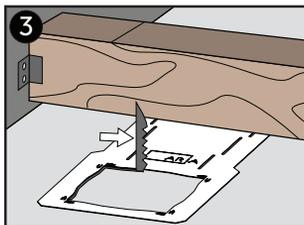
3 Note the location of the cutout before installing the drywall. Install drywall and cut using the **Smash Plate** as a guide. / Notez l'emplacement de la découpe avant de poser la cloison sèche. Posez la cloison sèche et découpez en utilisant la **Smash Plate** comme guide.
