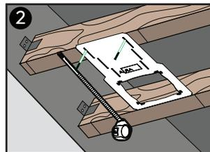
2 Secure **Smash Plate** to ceiling frame prior to drywall using nails or wood screws. / Fixez la **Smash Plate** à l'ossature du plafond avant de poser la cloison sèche à l'aide de clous ou de vis à bois.
