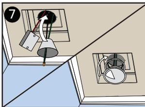
7 Connect wires and place components through hole. Individual pot-light install may vary. / Connecter les fils et placer les composants dans le trou. L'installation de chaque lampe peut varier.
