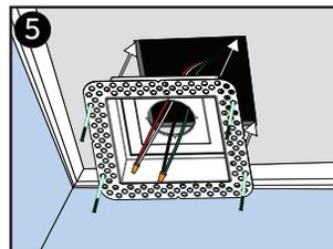
5 Secure **Mount** using staples or drywall screws. / Fixez le **Mount** à l'aide d'agrafes ou de vis pour cloisons sèches.
