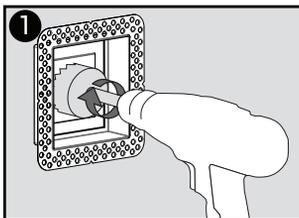
1 Drill hole in **Mount** according to the dimensions of the pot-light being used. / Percez un trou dans le **Mount** en fonction des dimensions de la lampe-pot utilisée.
