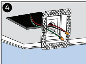
4 Disconnect power and feed wires through ceiling and **Mount**. / Débrancher l'alimentation électrique et faire passer les fils à travers le plafond et le **Mount**.
