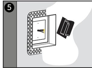
5 Use drywall compound mud to cover flange. Once dry, sand. Repeat as needed. / Utiliser de la boue pour cloisons sèches pour couvrir la bride. Une fois sec, poncez. Répéter l'opération si nécessaire.
