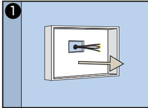
1 Shut off circuit breaker and disconnect existing device from wall. / Mettez le disjoncteur hors tension et débranchez l'appareil existant du mur.
