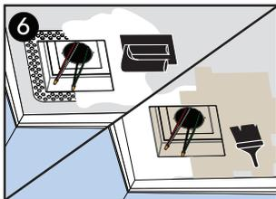
6 Use drywall compound mud to cover flange. Once dry, sand. Repeat as needed. Paint to match surface. / Utilisez de la boue pour cloisons sèches pour couvrir la bride. Une fois sec, poncez. Répétez l'opération si nécessaire. Peindre en fonction de la surface.
