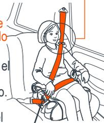
**Ver sección 6.13 página 26 Uso y ajuste del posicionador del cinturón de hombro del vehículo.** Tire hacia arriba o hacia abajo en el ajustador de correas hasta el hombro del vehículo El cinturón está centrado sobre el hombro del niño.
