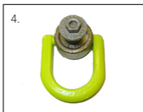
4. Setzen Sie die Schraube in die Buchse ein.
