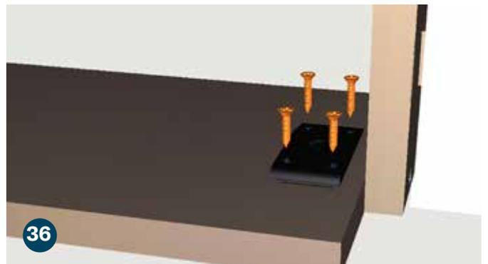
36 Retire la etiqueta adhesiva de la parte posterior de la cuña de polietileno colocándola sobre la ubicación marcada. El cono de la cuña debe mirar hacia adentro para una puerta que se abre hacia adentro y hacia afuera para una puerta que se abre hacia afuera. Asegúrelo con (4) tornillos Phillips de cabeza plana y punta afilada de 3/4" (L).
