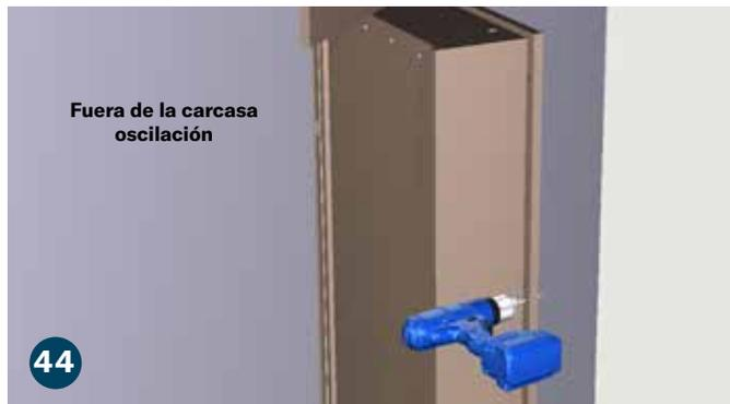
Con una broca de 1/8", taladre previamente cinco orificios en el marco de la cara de soporte izquierdo. Esto facilitará la instalación de la carcasa del lado izquierdo.
