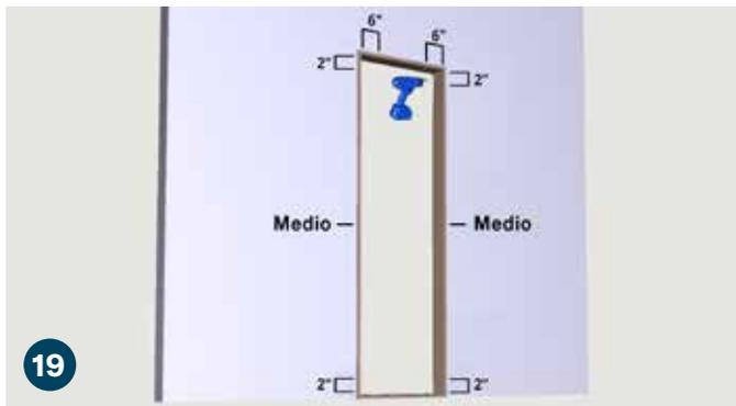
Con una broca de 1/8", taladre previamente y avellane tres orificios en cada lado de la jamba de la puerta a 2" de la parte superior de la jamba, a 2" de la parte inferior de la jamba y en el medio. A continuación, taladre previamente y avellanar dos orificios en la parte superior de la jamba a 6" de los lados derecho e izquierdo de la jamba.
