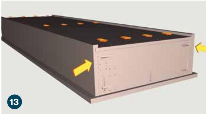
13 Asegúrese de que la parte posterior esté al ras con la parte superior de los lados de la librería y que la librería esté cuadrada. Los orificios pretaladrados en la parte posterior deben alinearse con la parte inferior de la parte posterior, el medio de la parte posterior y la parte superior de la parte posterior.
