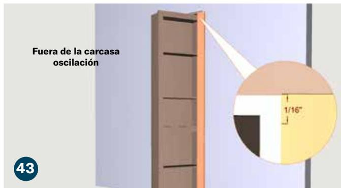
Recorte la carcasa derecha e izquierda para que encaje según sea necesario. Fije el marco derecho a la jamba de la puerta con un voladizo de 1/2" en el marco de la cara de la puerta.
