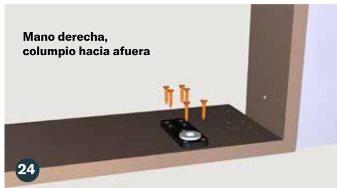
Instale la bisagra inferior de la jamba (H) en el umbral de la jamba usando (6) tornillos Phillips de cabeza plana y punta afilada de 1" (K), alineando la bisagra como se muestra.
