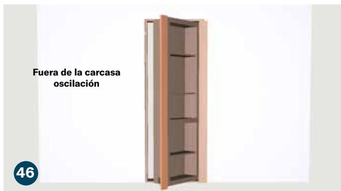
Coloque la carcasa del lado izquierdo. Pruebe el giro de la puerta antes de atornillarla para asegurarse de que no haga contacto con el piso.
