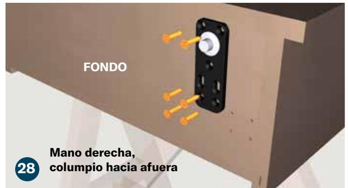
Haga coincidir la bisagra de pivote inferior (J) con los orificios pretaladrados en la parte inferior del ensamblaje de la estantería, como se muestra. Con la placa alineada, fije con (6) tornillos Phillips de cabeza plana y punta afilada de 1" (K).
