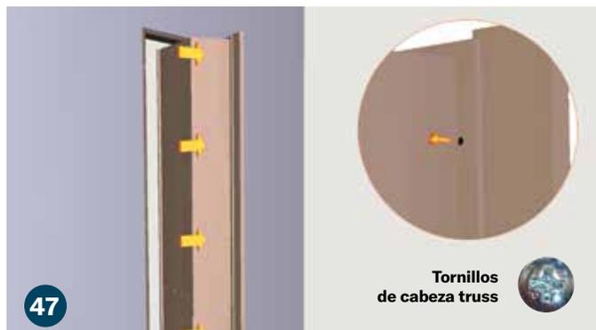
Asegúrelo con (5) tornillos de cabeza segmentada de 1-1/4" (D) asegurándose de no perforar el otro lado de la carcasa frontal.
