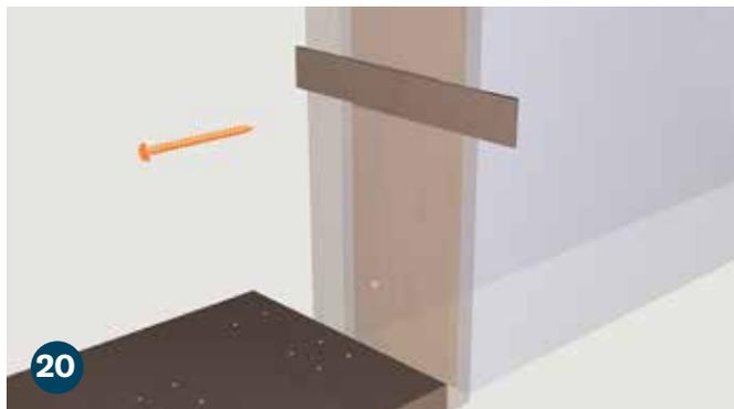
Usando cuñas donde sea necesario, instale (8) tornillos de jamba de 3" (F) asegurándose de que la parte superior y los lados de la jamba estén nivelados.
