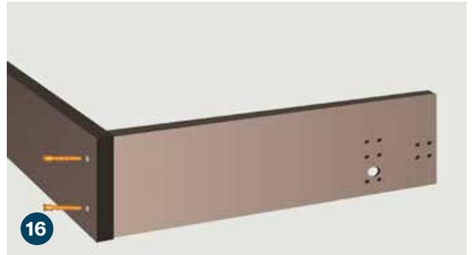
16 Coloque la parte superior de la jamba asegurándose de que los orificios para las bisagras pretaladrados estén del mismo lado que los orificios para las bisagras inferiores de la jamba. Después de asegurarse de que la esquina esté cuadrada; instale (2) tornillos de confirmación de 7 x 50 mm (E). Asegure la jamba lateral restante, asegurándose de que todas las esquinas estén cuadradas, con (4) tornillos de confirmación de 7 x 50 mm (E).
