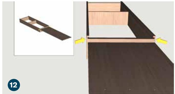
12 Con la ayuda de otro adulto, deslice suavemente la parte posterior hacia el interior del conjunto. Asegúrese de que la parte trasera se deslice en línea recta para evitar que se atasque.
