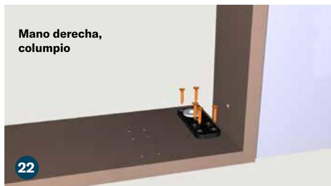
Instale la bisagra inferior de la jamba (H) en el umbral de la jamba usando (5) tornillos Phillips de cabeza plana y punta afilada de 1" (K), alineando la bisagra como se muestra.
