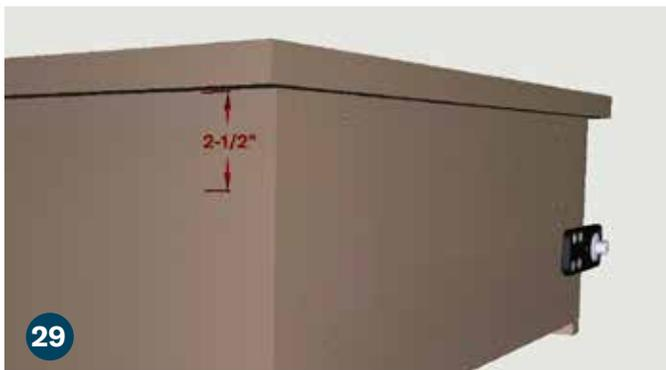
El pestillo de fricción de la puerta se instala en el lado de la puerta opuesto a la bisagra. Haga una marca a 2-1/2" de la parte posterior del marco frontal de la puerta.
