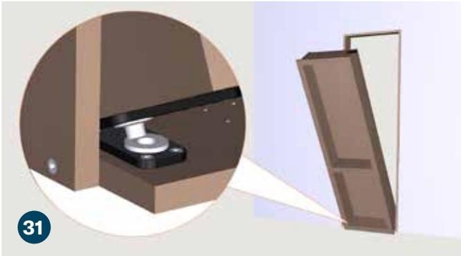
31 Coloque la puerta en la jamba de la puerta. Asegúrese de que la bisagra inferior se asiente en el cojinete de empuje plateado.
