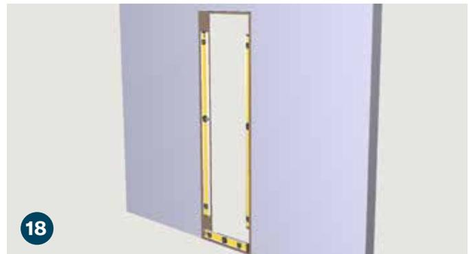
18 Es fundamental que el umbral inferior y los lados de la jamba estén nivelados. Si la jamba de la puerta no está nivelada y vertical, la puerta no girará ni cerrará correctamente.
