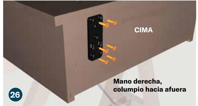
Para una puerta abatible hacia la derecha, alinee la bisagra como se muestra. Fije la placa de la bisagra superior (I) al ensamblaje de la librería superior con (6) tornillos Phillips de cabeza plana y punta afilada de 1" (K).
