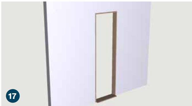
17 Coloque la jamba de la puerta en la abertura sin terminar. El umbral de la jamba inferior debe extenderse hacia la habitación hacia la parte posterior de la librería.
