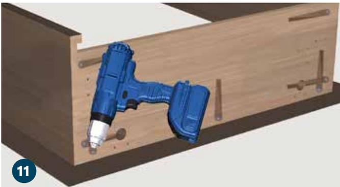
11 Retire las abrazaderas de madera y voltee el conjunto. Refuerce el marco frontal superior e inferior con (6) tornillos de cabeza cuadrada de 1" (B).
