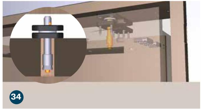
34 Para una puerta que abre hacia afuera, el pasador de la bisagra se inserta desde el lado frontal de la librería. Alinee el orificio en la parte superior de la librería con la bisagra superior de la puerta. Presione el botón del pasador de la bisagra e inserte el pasador de la bisagra. El pasador de la bisagra aparecerá avellanado cuando esté correctamente instalado y bloqueado en su lugar.
