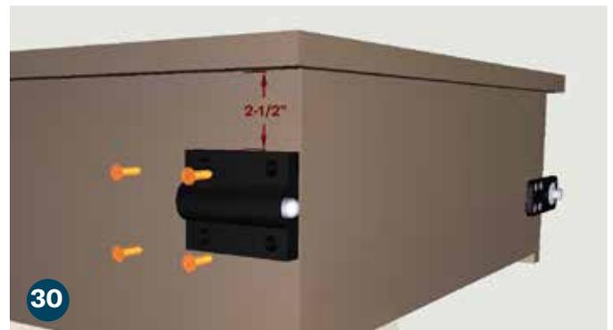
Coloque el pestillo de fricción de la puerta (M) en esta marca, al ras con la parte inferior de la puerta. Asegúrelo con (4) tornillos Phillips de cabeza plana y punta afilada de 3/4" (L).
