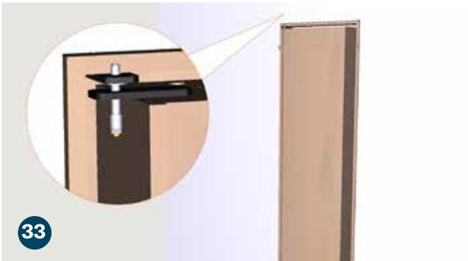
33 Para una puerta que se abre hacia adentro, alinee los orificios de la bisagra superior de la jamba del librero con los orificios de la bisagra superior de la puerta. Oprima el botón del pasador de la bisagra e inserte el pasador de la bisagra en los orificios asegurándose de que el pasador encaje en su lugar.
