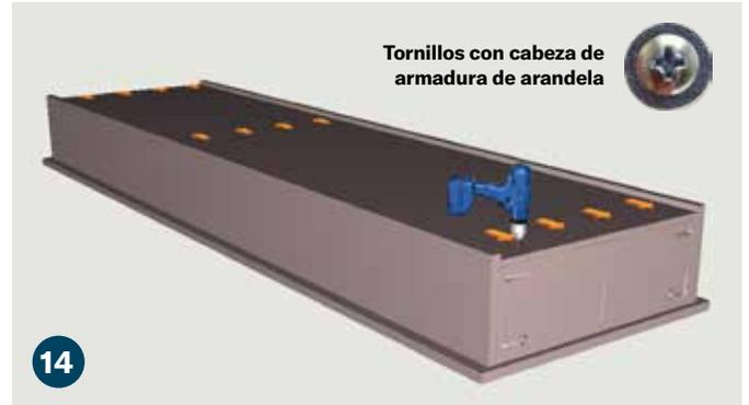
14 Usando la parte trasera como plantilla, taladre orificios guía en la parte superior trasera, el centro trasero y la parte inferior trasera con una broca de 1/8". y la parte inferior trasera usando (12) tornillos de cabeza segmentada con arandela de 1-1/4" (D).
