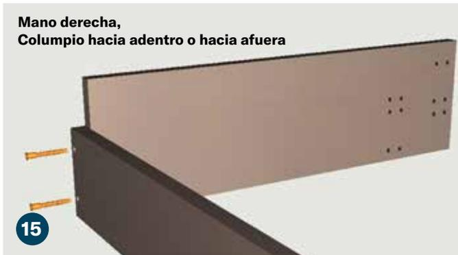
15 Alinee el umbral inferior de la jamba y 1 lado de la jamba sobre una superficie plana. Los orificios para bisagra pretaladrados en el umbral inferior de la jamba estarán a la derecha para abrir o cerrar con la mano derecha, y a la izquierda para abrir o cerrar con la mano izquierda. Después de asegurarse de que la esquina esté cuadrada; instale (2) tornillos de confirmación de 7 x 50 mm (E).
