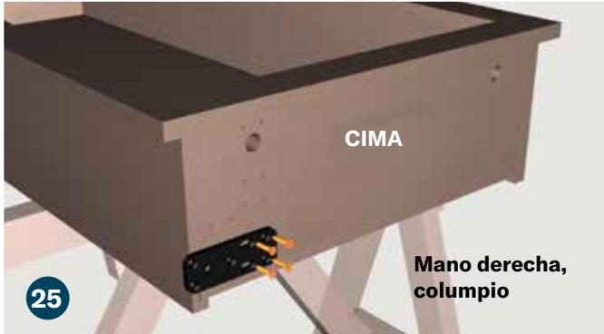
Para una puerta abatible hacia la derecha, alinee la bisagra como se muestra. Fije la placa de la bisagra superior (I) al ensamblaje de la librería superior con (4) tornillos Phillips de cabeza plana y punta afilada de 1" (K).
