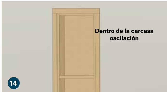
Aplique una gota de pegamento a lo largo del borde frontal de ambas jambas laterales y de la jamba superior. Alinee los clips en la carcasa superior de la misma manera que lo hizo en el costado y presione firmemente en su lugar. Ajuste la carcasa superior y lateral hasta que queden al ras una contra la otra y queden cuadradas.
