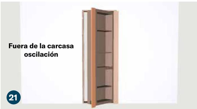
Coloque y fije la carcasa del lado izquierdo. Pruebe el giro de la puerta antes de atornillarla para asegurarse de que no haga contacto con el piso.
