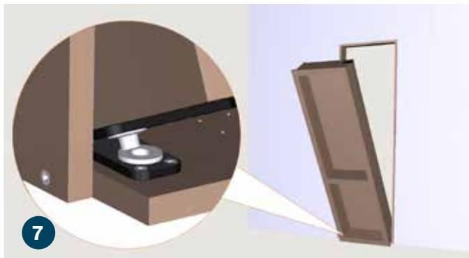
7 Coloque la puerta en la jamba de la puerta, asegurándose de que la bisagra del pivote inferior se asiente en el cojinete de empuje plateado.
