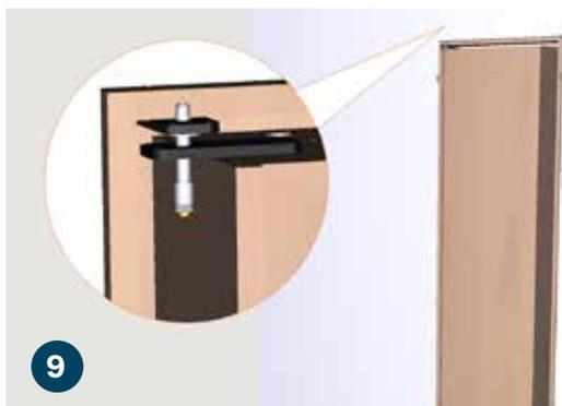
9 Alinee los orificios de la bisagra superior de la jamba del librero y la bisagra superior de la puerta. Presione el botón del pasador de la bisagra e insértelo asegurándose de que encaje en su lugar. En una puerta que abre hacia afuera, el pasador se insertará desde el frente de la librería y aparecerá avellanado cuando esté correctamente cerrado.
