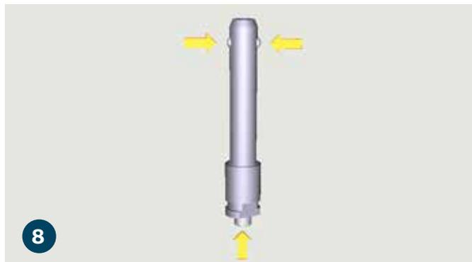
8 Presione hacia abajo la bola de bloqueo del pasador de la bisagra para retraer los dos pasadores superiores.
