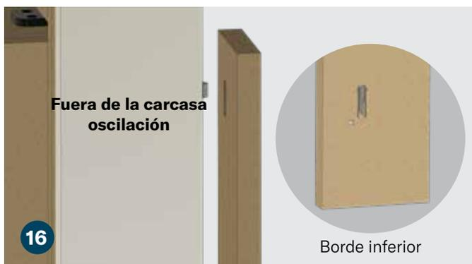
Alinee los clips en la carcasa y en la jamba. Presione firmemente en su lugar. El borde inferior está indicado con un pequeño orificio perforado en la parte posterior cerca del bolsillo inferior del clip.
