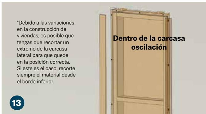
Alinee los clips en la carcasa y en la jamba. Presione firmemente en su lugar. El borde inferior está indicado con un pequeño orificio perforado en la parte posterior cerca del bolsillo inferior del clip. El borde superior de la carcasa lateral debe quedar aproximadamente 1/2" por debajo de la parte superior de la puerta. Si es más alto, agarre firmemente la carcasa lateral y deslícela hacia abajo hasta que se detenga.
