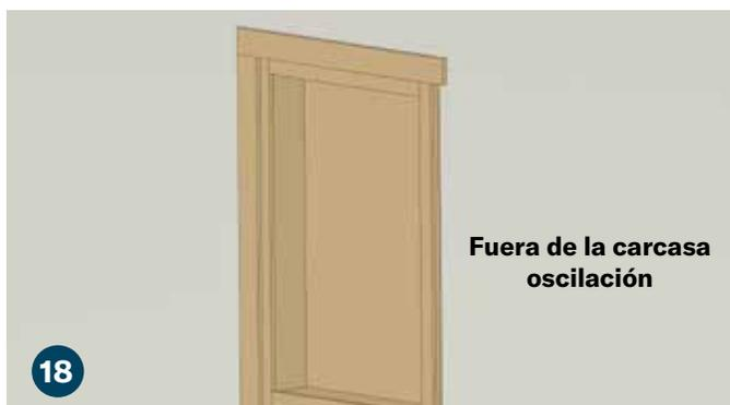
Alinee los clips en la carcasa superior de la misma manera que lo hizo en el costado y presione firmemente en su lugar. Ajuste la carcasa superior y lateral hasta que queden al ras una contra la otra y el espacio entre la carcasa superior y la parte superior de la puerta sea uniforme.
