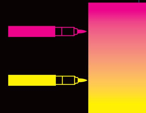
Halten Sie die Spitze des weißen Markers 5 bis 60 Sekunden lang vertikal mit einem anderen Marker zusammen. Der untere Marker ändert vorübergehend seine Farbe in die Farbe des oberen Markers – so erhalten Sie einen Farbton, der sich von dunkel zu hell oder umgekehrt ändert.
