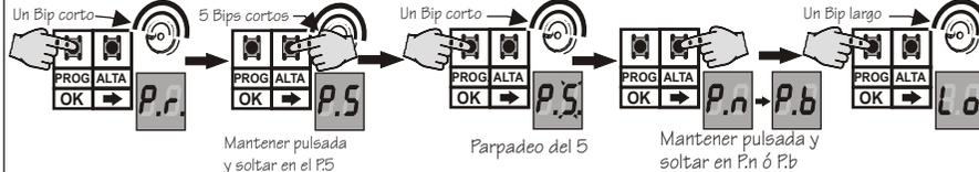
**Configurar S2:** La centralita sale por defecto con el relé de la salida 2 en modo normal "P.n". Si se quiere activar y desactivar el relé cuando se desee hay que seleccionar la configuración biestable "P.b". (Ver pag.5 menú 6). Los pasos para cambiar a "P.b" ó "P.n" son los siguientes:
