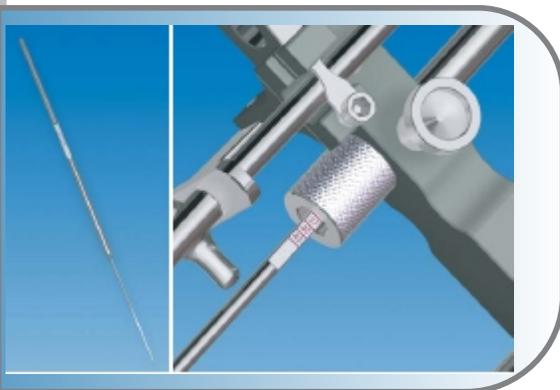
El medidor de profundidad se emplea para medir la longitud del tornillo de hueso necesario.
