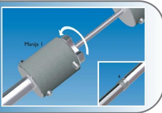
La manija 1 se desliza hacia delante hasta que los dientes del desatornillador queden ajustados en los cortes (a) de la rosca de la espiga del tornillo. Los dientes se fijan en su posición girando la tuerca "N" hacia abajo hasta la manija 1, manteniéndolos alineados con los cortes mientras se realiza la acción. Se debe tener cuidado de no apretarlos en exceso, ya que esto puede perjudicar la alineación.
