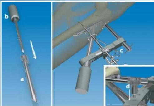
El manguito principal (a) y el trocar de cuello (b) se introducen ahora por el orificio oblicuo más distal del mango introductor. Este proceso se realiza con facilidad utilizando el retractor de piel (c) proporcionado. El manguito principal se fija ahora en su posición con un perno (d) insertado a través del mango introductor. El trocar se retira.
