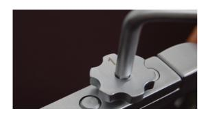
5.- Coloque el estabilizador en "T" e introduzca el candado que se va a utilizar en las ranuras del estabilizador.
