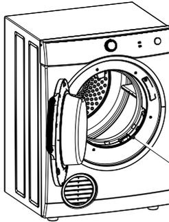
Filtro de pelusas está ubicado en el frente de la secadora en la parte inferior de la apertura de la puerta
