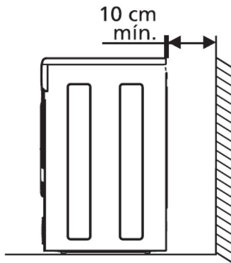
La secadora debe colocarse en un área ventilada y a una distancia de 10 cm por lo menos del muro trasero.
