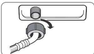
5. Conectar el otro extremo de la manguera en la válvula de entrada de agua de la lavadora.
