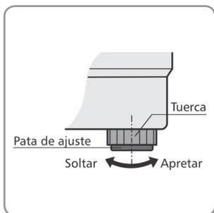
1. Nivele su lavadora soltando la pata ajustable y apretando la pata para evitar sacudidas y/o desplazamientos durante el proceso de lavado y centrifugado.
