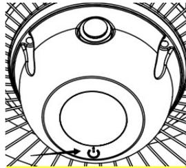
1. · Presione el interruptor ON/OFF para activar el calentador.
