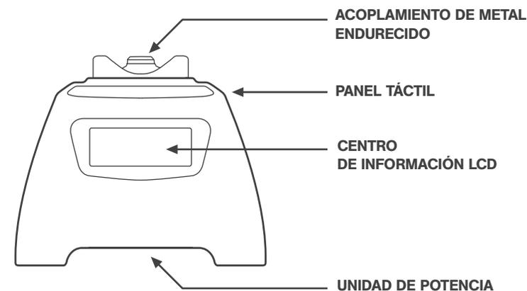
**FIGURA 2 VISTA LATERAL: MONTAJE DE LA BASE DEL MOTOR Y JARRA**
