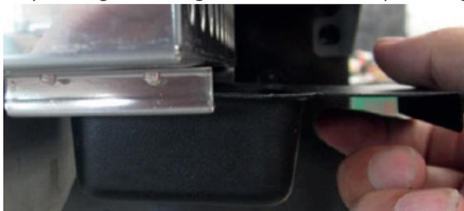
N) Destornille tapa del panel de encendido, e inserte pila batería AAA, con el lado positivo hacia el exterior. Vuelva a atornillar tapa.
