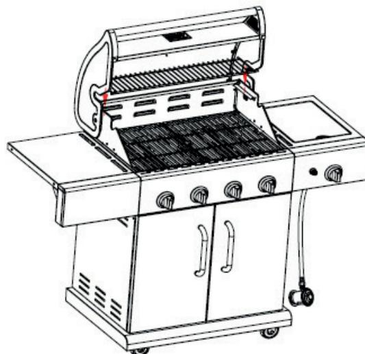
**Paso 9: Instalar bandeja receptora de grasas y canasto receptor de grasas**
