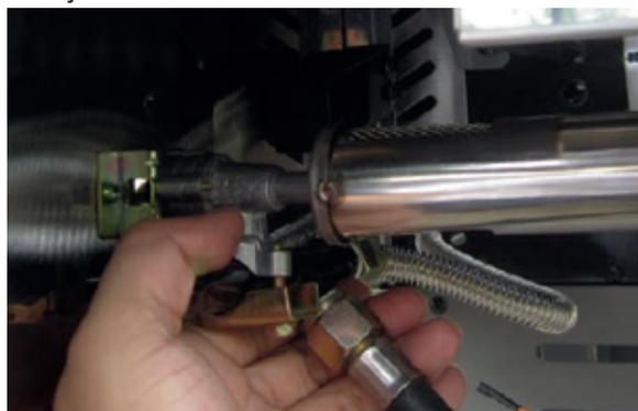
F) Luego atornille los 2 tornillos que se guardaron aparte del vástago de la válvula, pero no apriete completamente hasta ensamblar el asiento de perilla al lado de la parrilla.
