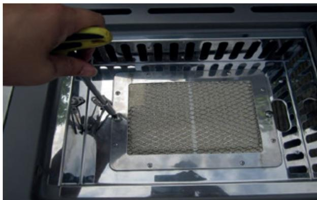
H) Volver a instalar encendedor a la bandeja con los tornillos previamente soltados del quemador infrarrojo (Etapa D).
