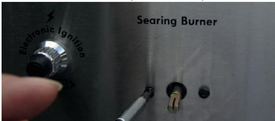
G) Volver a ensamblar quemador infrarrojo a la bandeja derecha con 2 los tornillos previamente soltados (Etapa D).
