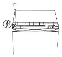
8. Instale la cubierta superior y fíjela con los dos tornillos en la parte posterior.
