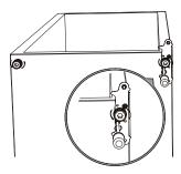
5. Destornille y retire el pasador de la bisagra inferior, gire el soporte y reemplácelo.
