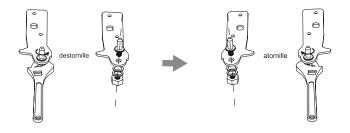
6. Coloque el soporte en el pasador de la bisagra inferior. Reinstale ambos pies ajustables.
