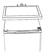
3. Destornille la bisagra superior y luego retire la puerta y déjela sobre una superficie acolchada para evitar arañazos.
