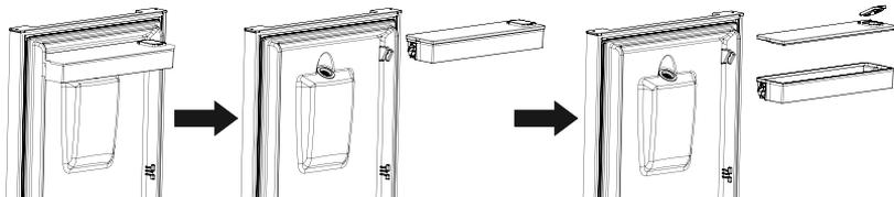
2. Después de la limpieza, vuelva a instalar el tanque de agua, tape e instale el tanque de la siguiente manera:
