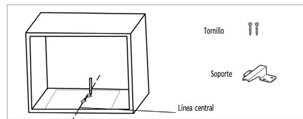
3. Retire la plantilla del cajón inferior y fije el soporte con tornillo.
