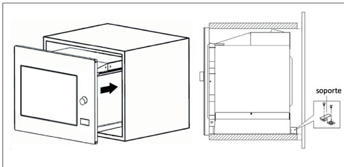
5. Abra la puerta, fije el horno al cajón con un tornillo, en el orificio de instalación. A continuación, fije la cubierta de plástico Trim-kit al orificio de instalación.
