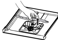
Para desmontar el brazo rociador superior, mantenga inmóvil la tuerca en el centro y gire el brazo rociador en sentido contrario a las agujas del reloj.
