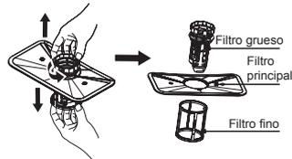
El filtro fino se puede extraer de la parte inferior del conjunto del filtro. El filtro grueso se puede separar del filtro principal apretando suavemente las lengüetas de la parte superior, y tirando de él.
