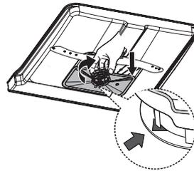
Vuelva a ensamblar los filtros en el orden inverso al del desmontaje, reemplace el inserto del filtro y gírelos en el sentido de las manecillas del reloj hasta la flecha de cierre.
