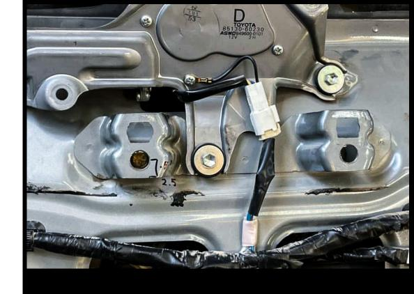
DON'T WORRY IF YOU ARE SLIGHTLY OFF, THE BRACKET HAS SLOTS TO MAKE IT EASIER TO INSTALL ONCE THE HOLES ARE DRILLED.
