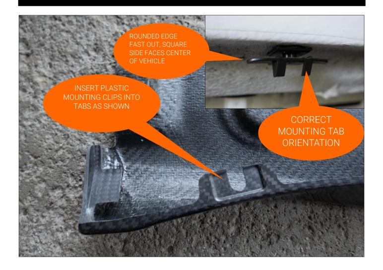
**WARNING:** INSTALL CLIPS IN SIDE SKIRTS FIRST, DO NOT INSTALL IN ROCKER PANELS OF CAR BEFORE SKIRTS. YOU WILL STRUGGLE TO GET THE CLIPS INTO THE SIDE SKIRTS IF THEY ARE NOT INSTALLED ON THE SKIRTS PRIOR TO MOUNTING.
