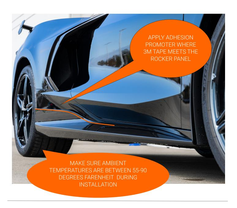
INSTALL SIDE SKIRT BY SLIDING THE FORWARD EDGE BETWEEN ROCKER PANEL AND MUD FLAP TAB. ALIGN REAR END OF SIDE SKIRT WITH FASTENER HOLES AND REINSTALL 7MM FASTENERS
