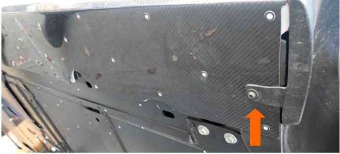
PUSH SIDE SKIRT FLUSH AGAINST ROCKER PANEL AND SLOWLY PULL TAPE BACKING WHILE HOLDING SIDE SKIRT IN PLACE -DOUBLE CHECK FOR ANY GAPS BEFORE PULLING TAPE-
