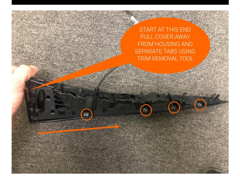
INSTALL CARBON FIBER DOOR HANDLE COVER BY SLIDING TABS OVER HOUSING
