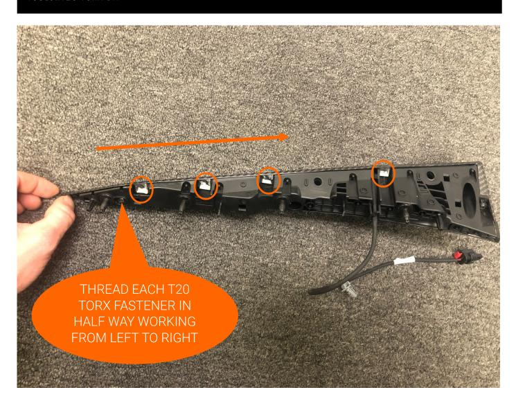
TIGHTEN TORX FASTENERS WORKING FROM LEFT TO RIGHT AS PICTURED BELOW
