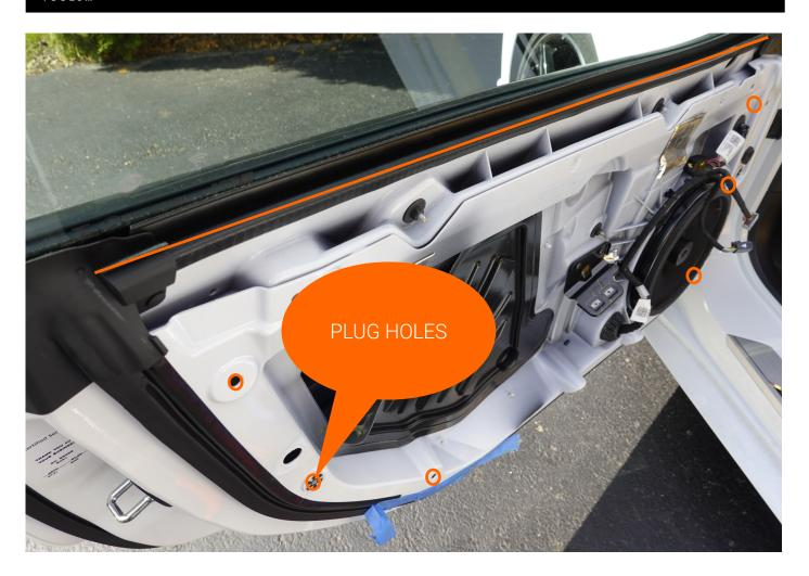
REINSTALL TWO 7MM FASTENERS INTO DOOR PANEL POCKET @TWO T30 TORX FASTENERS ALONG THE BOTTOM EDGE OF DOOR PANEL
