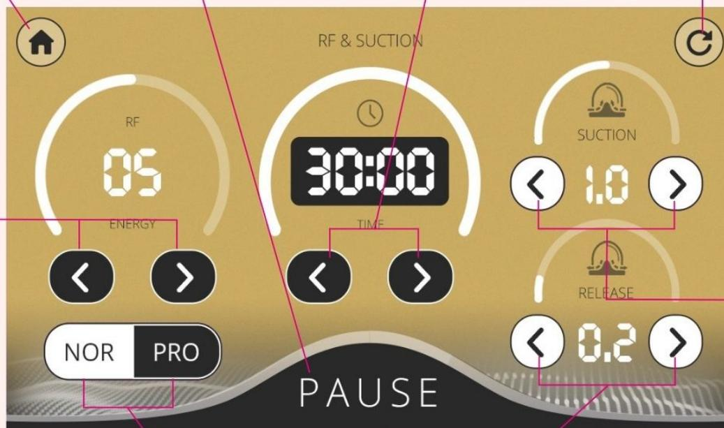
Appuyez sur le bouton [ - ] ou [ + ] pour diminuer ou augmenter l'intensité de la radiofréquence de 1 à 10 niveaux.
