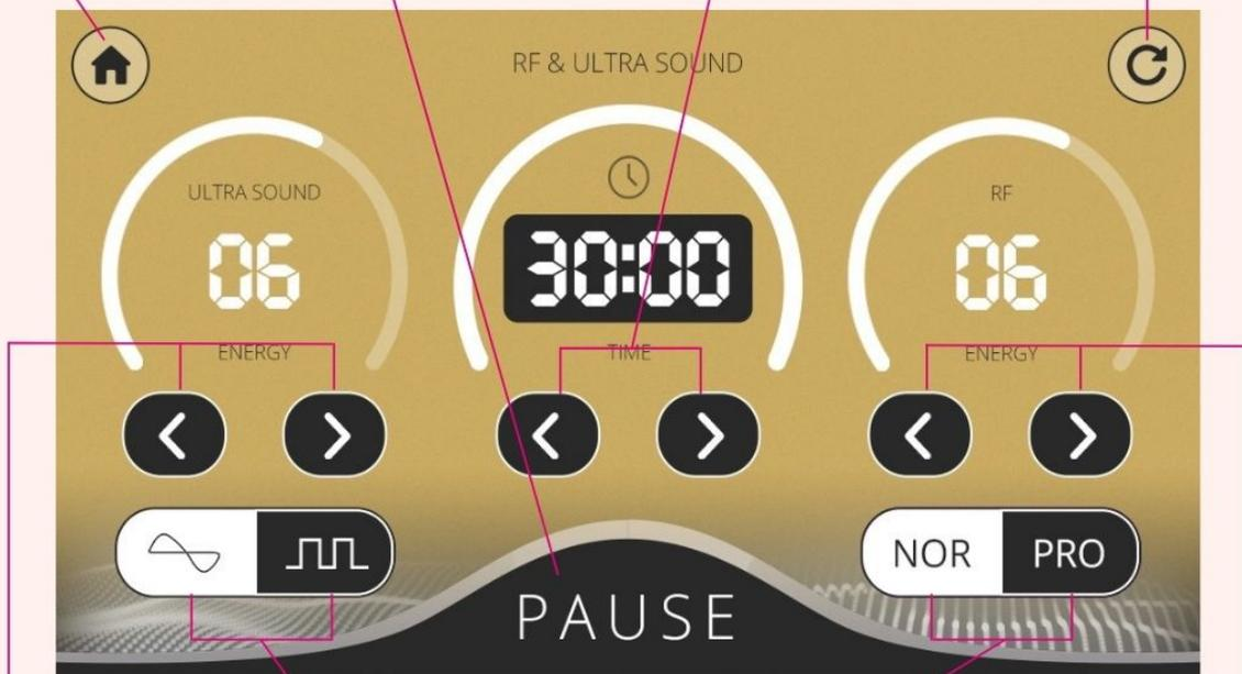
Appuyez sur le bouton [ - ] ou [ + ] pour diminuer ou augmenter l'intensité de la cavitation de 1 à 10 niveaux.
