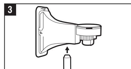
**4** Inserte la barra en el conjunto del soporte deslizante de montaje en la pared con las cejas de cierre alineadas en el lado derecho y las flechas orientadas hacia arriba.
