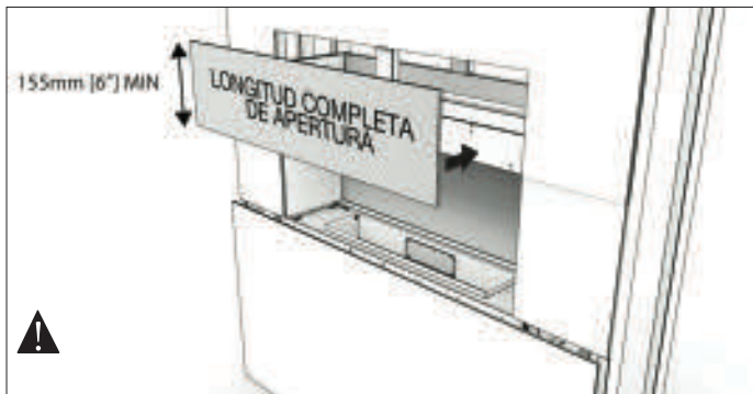
Ejemplo: Chimenea de una cara
