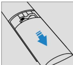
1. Öffnen Sie die Batterieabdeckung der Fernbedienung.
