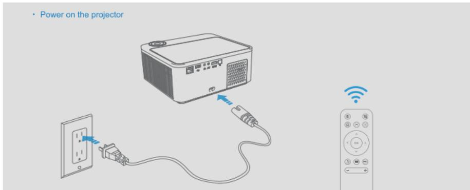
Nach dem Anschließen des Netzkabels leuchtet die Kontrollleuchte auf. Drücken Sie dann die Netzschaltertaste am Projektor oder auf der Fernbedienung, um innerhalb von 2 bis 5 Sekunden in die Multimediakommoden-Schnittstelle zu gelangen.
