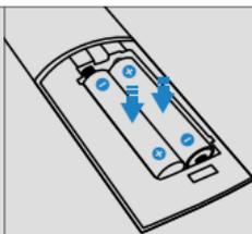
2. Setzen Sie die Batterien mit den + und - Enden gemäß den Anzeigen auf dem Batteriefach ein.
