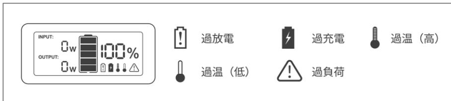
**INPUT:**本機に蓄電を行う際に接続されたソーラーパネル、ACアダプター、シガーソケットから供給されている電力が表示されます。
